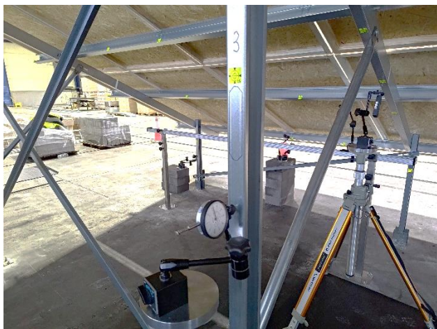
Rys. 3.4 Rozmieszczenie przyrządów pomiarowych.
