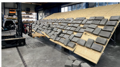
Fot. 3. Zniszczenie konstrukcji K-2
