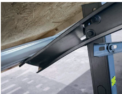
Fot. 4. Zniszczenie połączeń słup–krokiew i krokiew–płatw w konstrukcjach K-1 (z lewej) i K-2 (z prawej)
